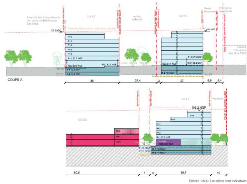
Figure 361 : Coupe de principe des bâtiments du lot 4.3 (Source : fiche de lot)
